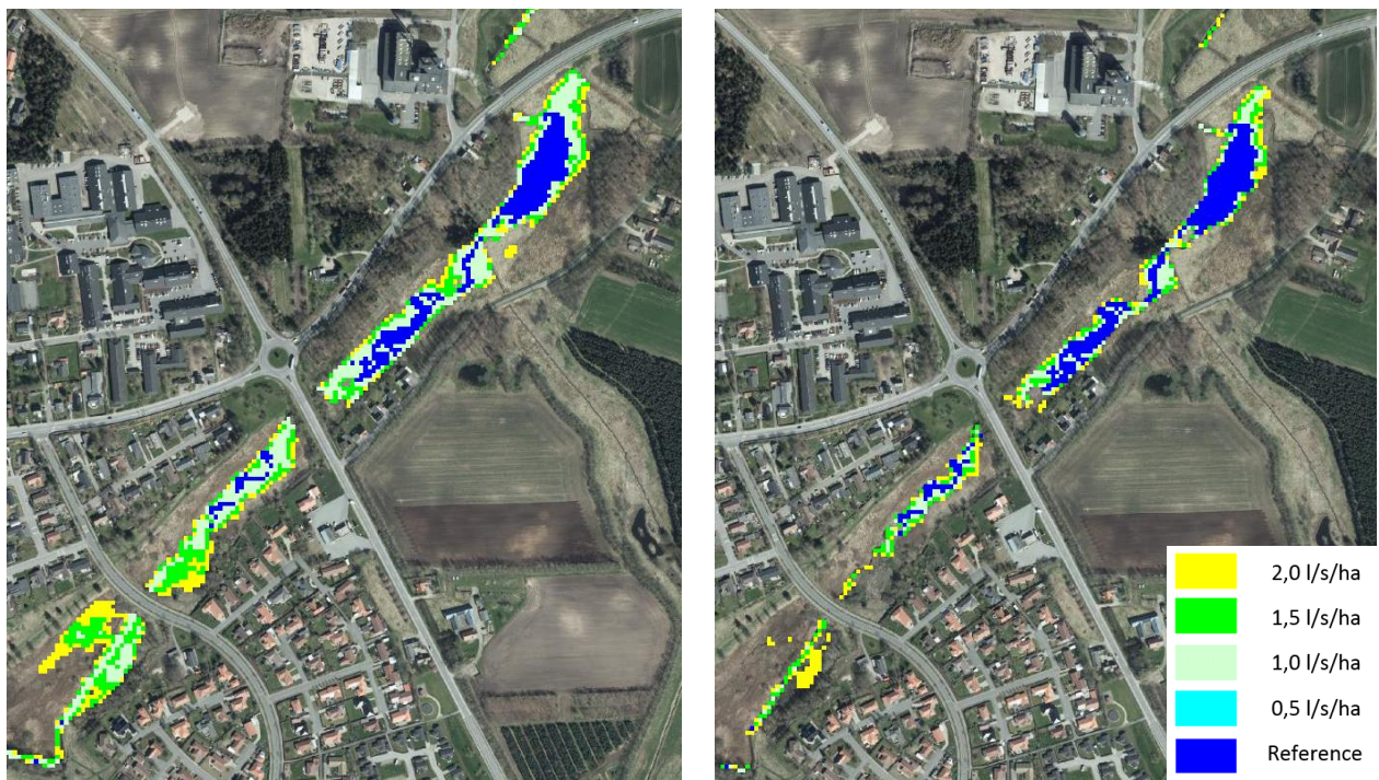
Figur 7. Oversvømmelsesscenerier ved udledningsniveauer på op til 2 l/s/ha langs Herredsbækken i den østlige del af Aars. Resultat for sommersituation til venstre, vintersituation til højre.
